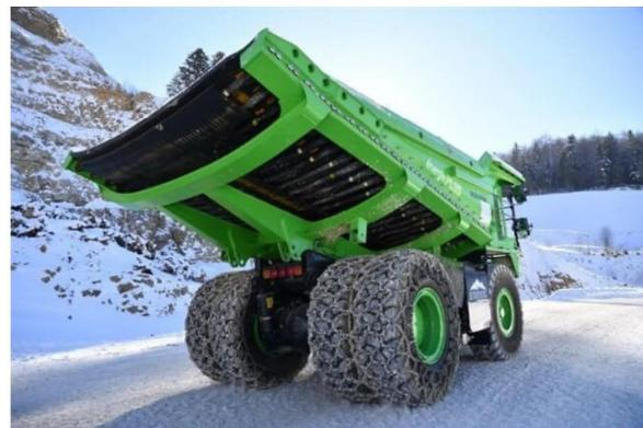
*Eine weitere Besonderheit des „E-Dumpers“ ist die neukonstruierte Stahl-/Gummi-Kippmulde, die ein problemloses Abladen ohne frostbedingte Anbackungen auch im Winter ermöglicht.*
