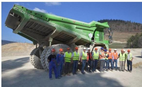
*Das größte batteriegetriebene Fahrzeug der Welt mit der größten mobilen Batterie der Welt: Seit Jahresbeginn ist der umgerüstete Elektro-Großdumper im Steinbruch der Schweizer Zementfabrik Vigier im Einsatz. | Fotos: Kuhn Schweiz*
